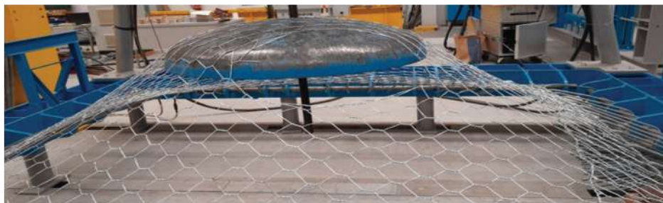
Skúška ocelevej siete – punching shear test
