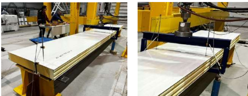
Overenie odolnosti a tuhosti sendvičových stenových a strešných panelov
