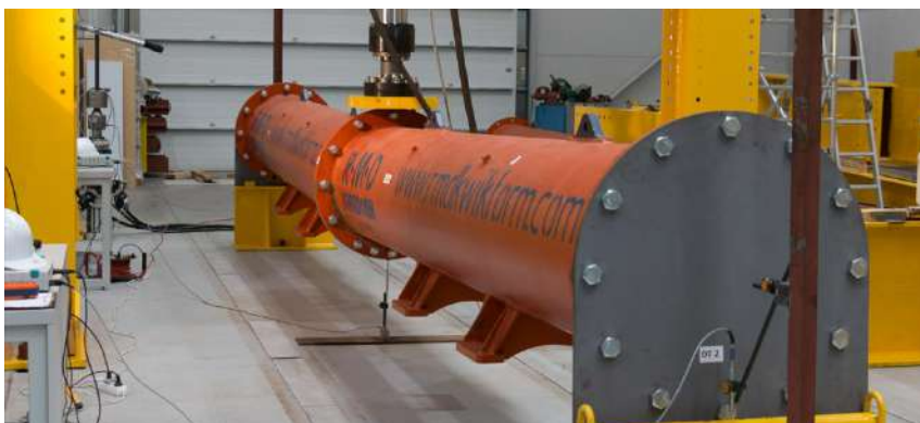
Overenie odolnosti a tuhosti sendvičových stenových a strešných panelov
