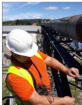
Diagnostika ocelevej konštrukcie technologickej lávky – korozívne úbytky
