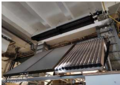
Obnoviteľný zdroj energie pre vykurovanie a prípravu teplej vody v podobe solárnych panelov s použitím rôznych variant
