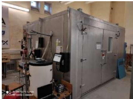
Klimakomora určená na experimentálny výskum stavebných materiálov
