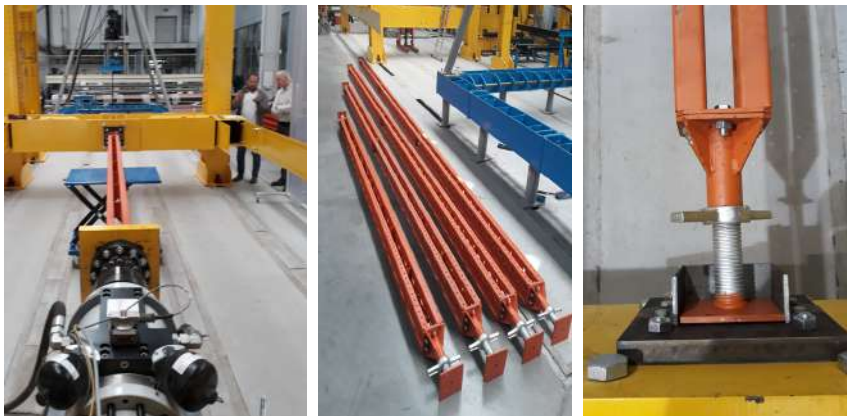
Overenie vzpernej odolnosti ľahkých – modulárnych podporných systémov
