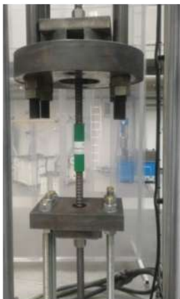
Statické a únavové skúšky horninových kotiev
