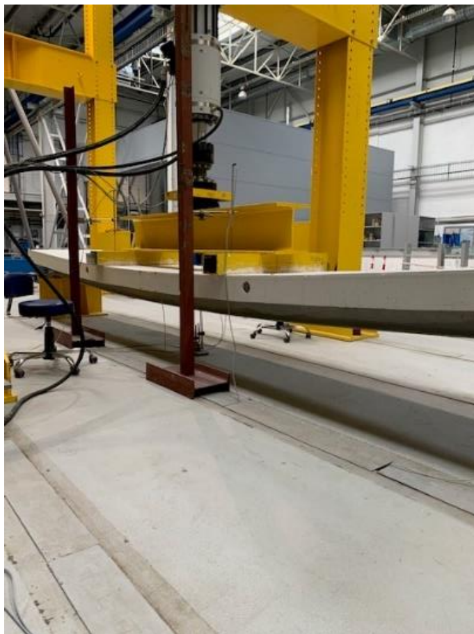
Obr. 3: Štvorbodová ohybová skúška experimentálneho kompozitného nosníka
