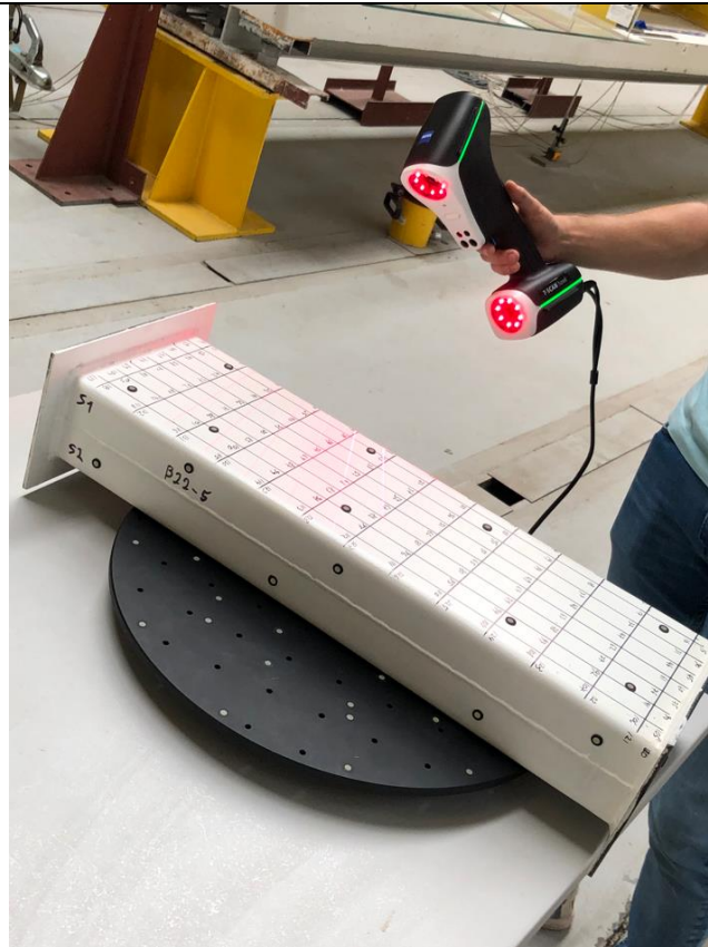
Obr. 1: Meranie začiatkových imperfekcií tenkostenných prútov 3D skenerom
